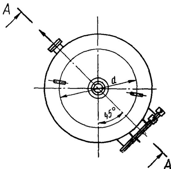
Допускается по требованию заказчика выполнять верхний люк (поз. 5) с условным диаметром, равным 800 мм, и с другим расположением
